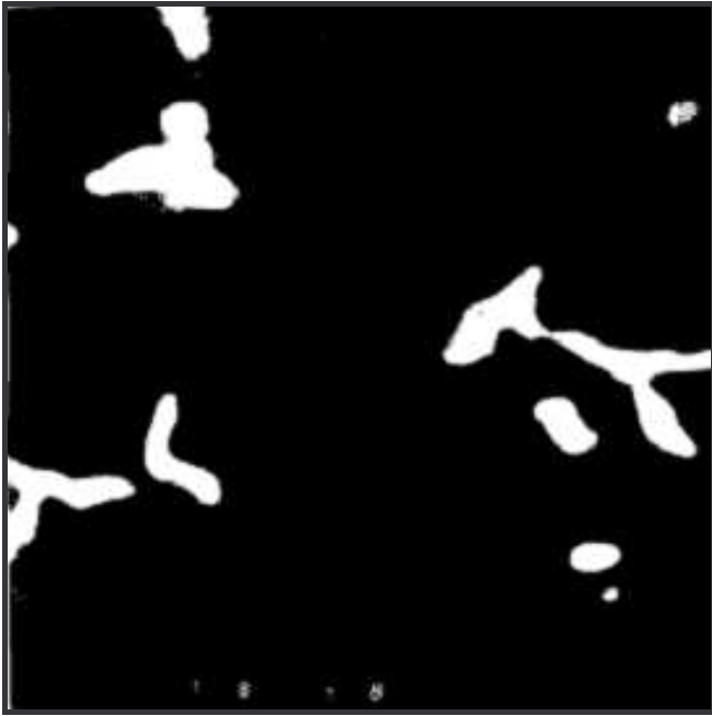
Fig. 3.8 Imaginea de compoziție a fazelor aliajului \text{AlZn}_5\text{Mg}_2\text{CuCr} Mărire: 1200:1
